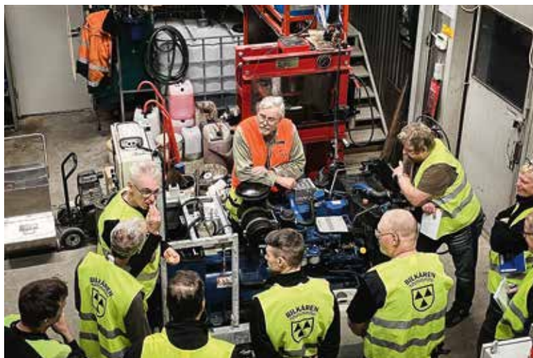
➔ Genomgång av dieselmotorns funktion under elverksoperatörskursen.
